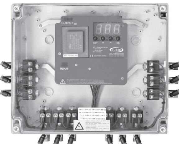
Секвенсер предназначен для управления (по таймеру) импульсными клапанами управляемых аккумулируемых аспирационных блоков. Он имеет 2 выходных контактных реле и 2 цифровых входных контакта. Имеет светодиодный дисплей (0,8" 3-значный 7-сегментный), который позволяет считывать рабочее состояние таймера, активные электромагнитные клапаны и аварийные сигналы (при наличии).
